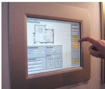
個別のスイッチのほかに、全ての照明、ブラインドなどの制御が1つのタッチパネルでコントロールできるシステムです。玄関脇の壁面に取り付けられ外出時の照明の消し忘れも防止できます。
