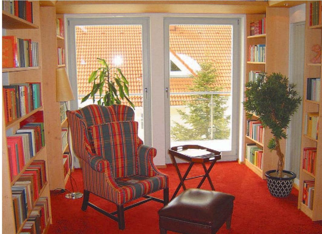
ドレーキップは窓サイズの用途だけではありません。テラスに通じる出入り口に配置しドアとして使うことも可能です。もちろん内倒しにして換気を行うことができます。シリンダー錠を取り付けることもできます。高さは2,200mmまで製作が可能です。幅は最大1,400mmですがガラス重量により制限を受けますので注意が必要です。
